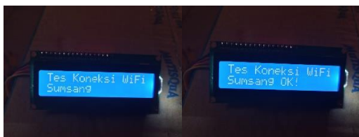
Gambar 9. Hasil Pengujian ESP8266
