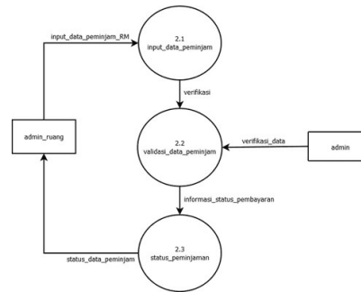
Gambar 5. Data Flow Diagram (DFD) level 1 proses input data peminjam.
